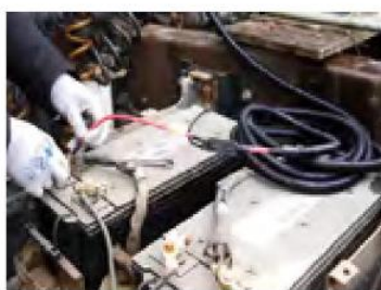
5. Подключить провода электропитания к АКБ
